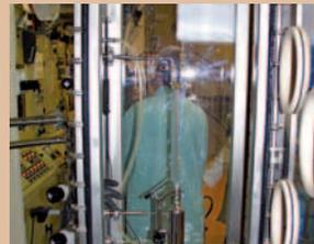
Le gaz prélevé par chauffage haute fréquence est récupéré par pompage Toeppler dans une ampoule de verre, placée en boîte à gants. Cette ampoule est ensuite analysée par spectromètre de masse ou chromatographie en phase gazeuse.
