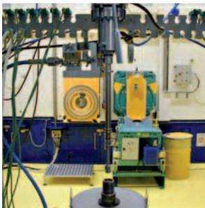
**La seconde installation située en enceinte M23** comporte quatre fours de fluage par pression interne de gaz (Argon) jusqu'à 1 000 bars. L'utilisation d'un gaz permet de fonctionner jusqu'à 700°C. Cette installation est utilisée pour les essais de fluage ou de relaxation.
